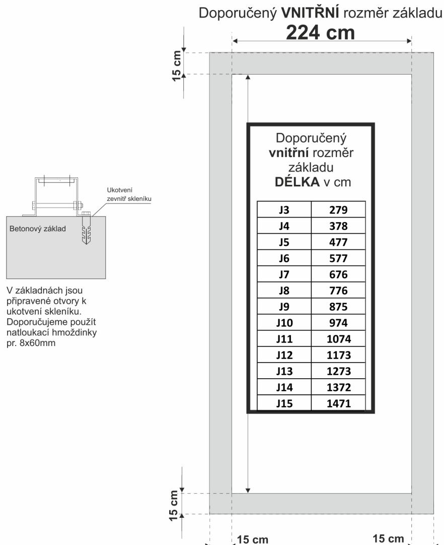
Doporučujeme pevné betonové základy ( lze použít i ztracené bednění). Pouze v případě řádného ukotvení skleníku k pevným základům lze dát plnou garanci za stabilitu skleníku dle statických výpočtů.
