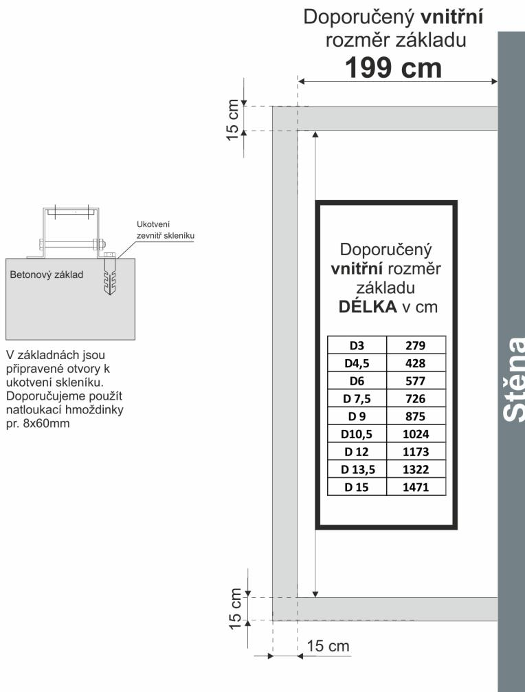
Doporučujeme pevné betonové základy ( lze použít i ztracené bednění). Pouze v případě řádného ukotvení skleníku k pevným základům lze dát plnou garanci za stabilitu skleníku dle statických výpočtů.
